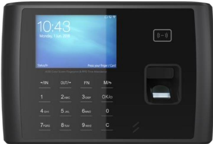
Verbinden Sie das Erfassungsterminal mit der Stromversorgung und dem Netzwerk. Drücken Sie danach die Taste **[OK]** um das Terminal zu starten. Nach einem kurzen Augenblick beginnt das Display zu leuchten. Konfigurieren Sie das Erfassungsgerät nun für Ihr Netzwerk:
