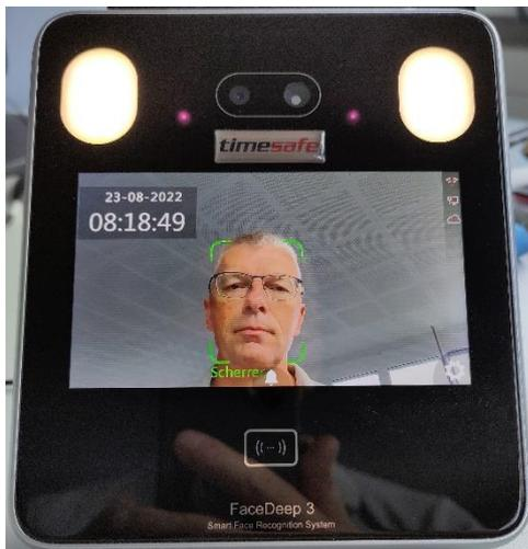
Verbinden Sie das Erfassungsterminal mit der Stromversorgung und dem Netzwerk. Nach dem Start sehen Sie sich selbst im Display des Terminals. Drücken Sie das «Zahnrad» unten rechts, um die Konfiguration aufzurufen.
