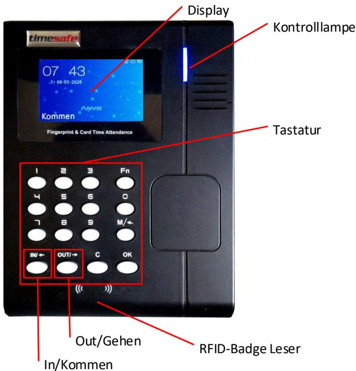
Verbinden Sie das Erfassungsterminal mit der Stromversorgung und dem Netzwerk. Nach einem kurzen Augenblick beginnt das Display zu leuchten. Konfigurieren Sie das Erfassungsgerät nun für Ihr Netzwerk:
